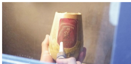
専用の箱の中で勢いよく砂が出るノズルを当てる
